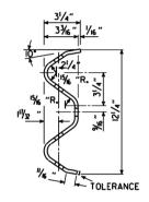
DETAILS OF W-BEAM GUARD RAIL
