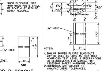
WOOD BLOCKOUT (W-BEAM) PLASTIC BLOCKOUT (W-BEAM)
